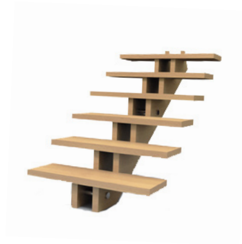
■ Escalier à double crémaillères centrées sur lesquelles sont posées les marches
