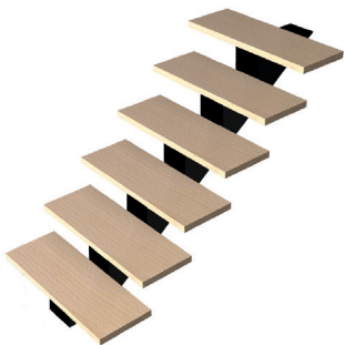
■ Escalier à limon central métallique
