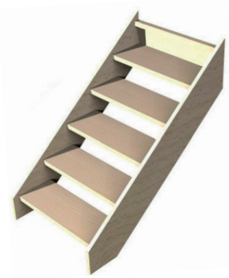
■ Escalier à la française Escalier disposant de 2 limons parallèles dans lesquels sont insérées les marches
